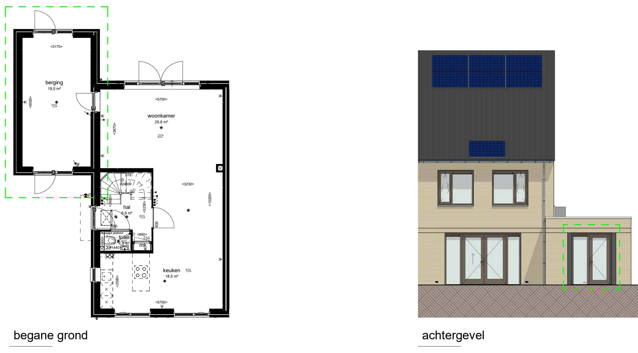
Optie A1.07: geïsoleerde verwarmde berging met binnendeur naar woonkamer
